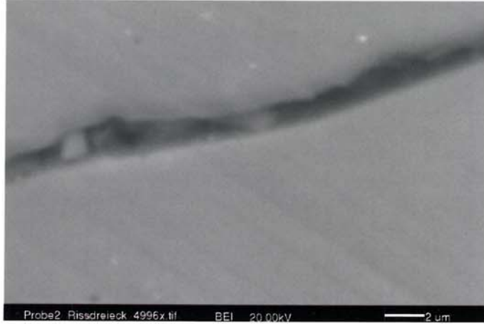
Şekil 3-4. Denseo Fairy ile tedavi edilen seramik numunedeki çatlağın en kesidini gösteren SEM resmi.
