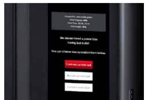
RESUME-Funktion für die Fortsetzung von aktiven Druckaufträgen auch nach einem Stromausfall
